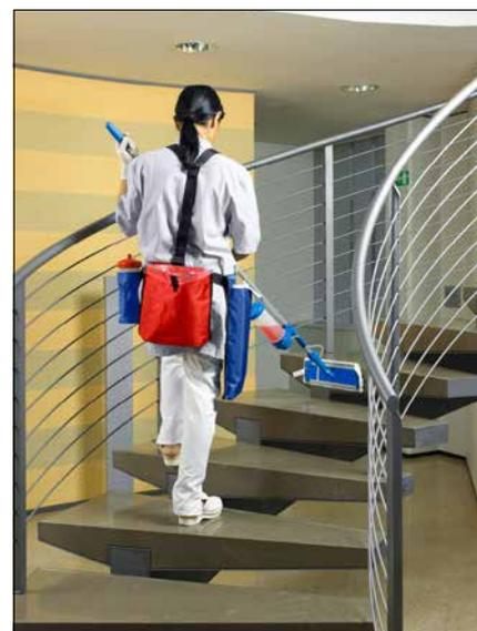
L'attrezzo **Sanety** è dotato di una particolare piastra dalla superficie forata, che permette di distribuire il liquido in modo uniforme, evitando così sprechi di prodotto.
