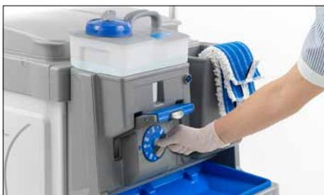
Ruotare la ghiera graduata da 50 a 350 ml per scegliere la giusta dose di soluzione. Se necessario, rimuovere la chiave di sicurezza per bloccare la ghiera e rendere inalterabile il dosaggio.
