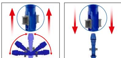
Telaio **GLOBO** - telaio pieghevole in plastica con bocchettone ErgoSwing
